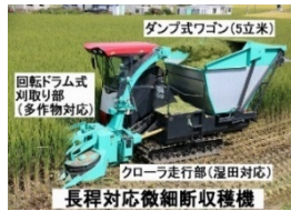
ダンプ式ワゴン(5立米) 回転ドラム式刈取り部(多作物対応) クローラ走行部(湿田対応) 長稈対応微細断収穫機
