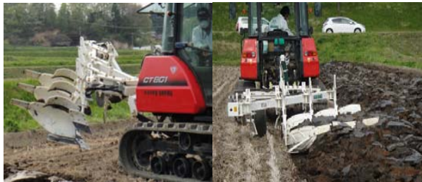
ジョインター付きプラウ (耕深30cm:トラクター牽引)
