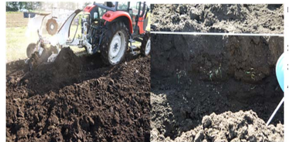
改良型二段耕プラウ (耕深45cm:トラクター牽引)
