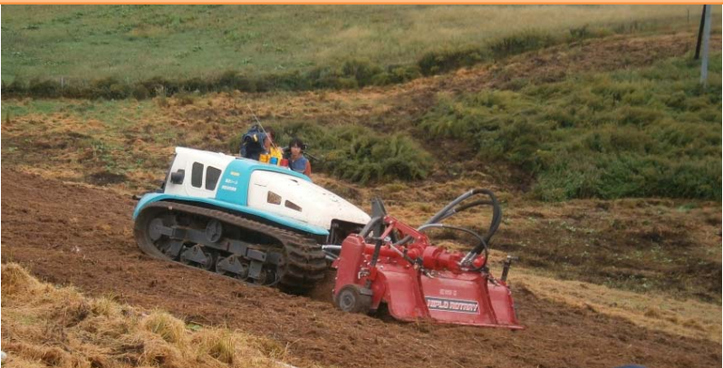
無線トラクタを利用した傾斜牧草地の除染 (草地更新)技術の開発
