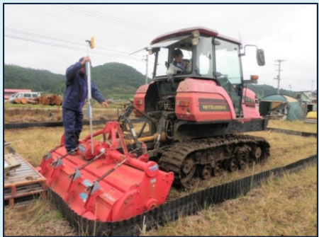
①レーザーレベルセンサー付き トラクターによる土壌解砕
