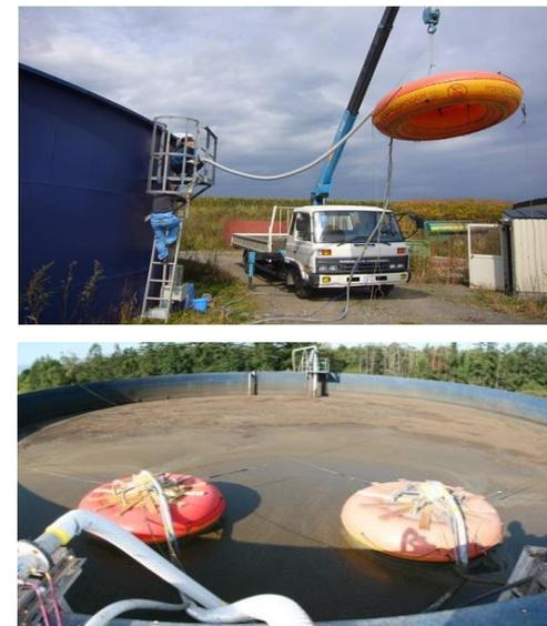
家畜排せつ物処理(スラリー処理)における実規模施設でのガス精密測定方法を開発し、日本の実情に併せ、インベントリに反映できるよう検討
