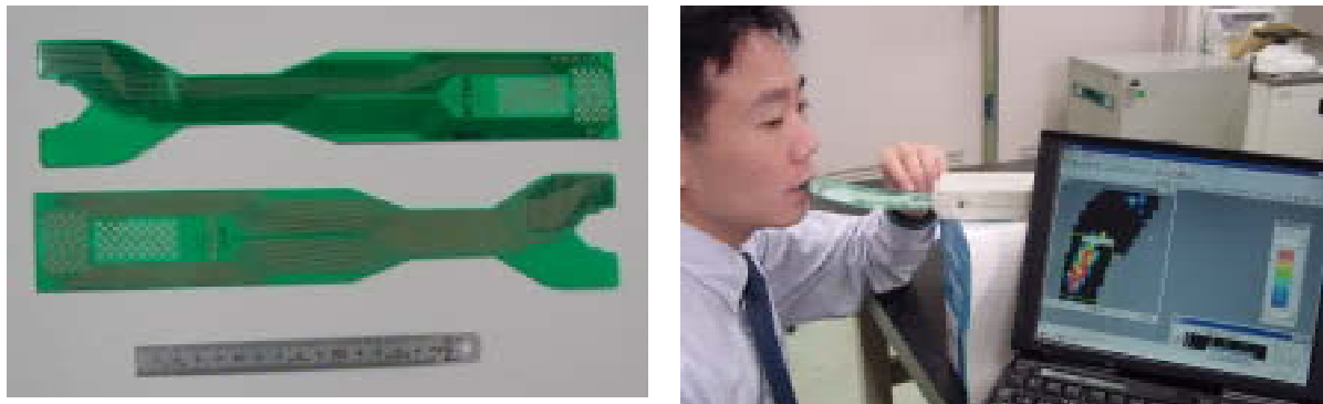
図 1 . MSCAN 2 シートセンサ ( 左 ) と臼歯による咀嚼実験風景 ( 右 )
