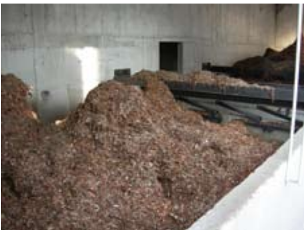
図1 製材所残材(樹皮パーク)をエネルギー利用する。オーストリア・ストラエンソ・イプス製材工場。
