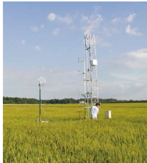
水田での二酸化炭素フラックスの長期観測装置
