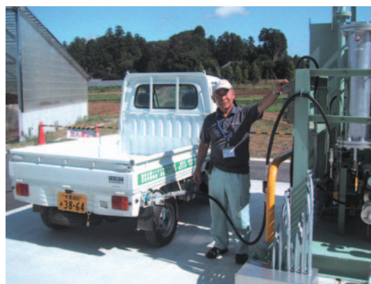
生産されたメタンガスを軽自動車に充填中
