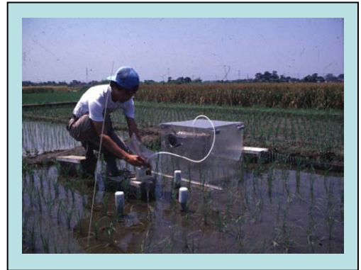
クローズドチャンバー法による土壌からのメタン発生測定の様子
