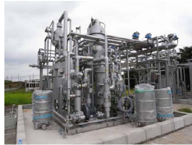
無触媒 バイオディーゼル燃料 製造実証プラント (千葉市花見川区)
