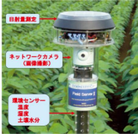
図2 フィールドサーバ(小型環境計測ロボット)
